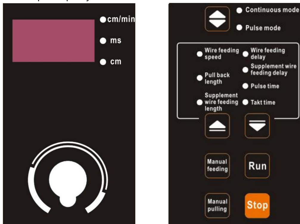
Slika 3-9 Diagram plošče podajalnika žice
