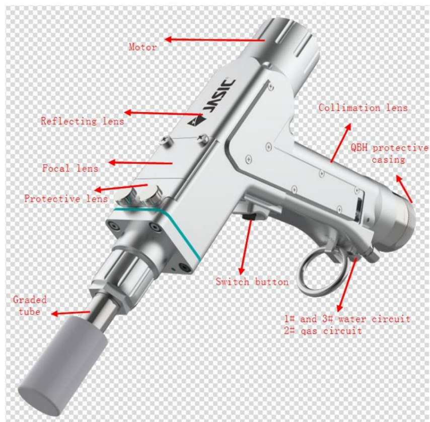
Slika 2-1 Diagram ročnega laserskega varilnega gorilnika
