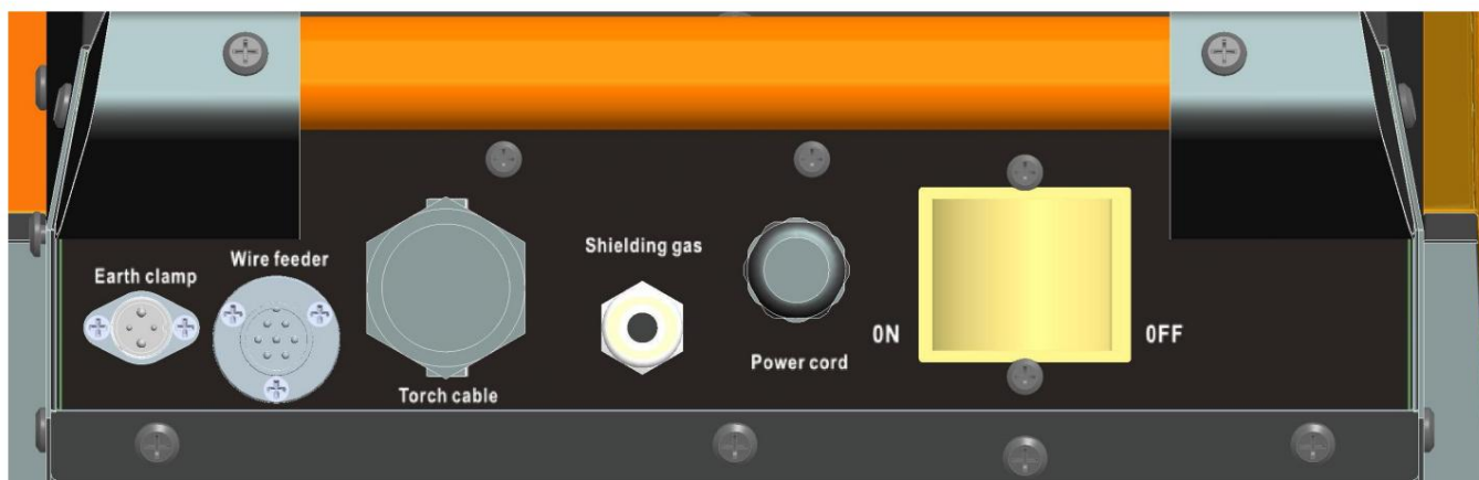
Slika 3-8 Shematski diagram zadnje plošče
